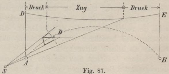
2. Der Schnittpunkt  $S$  der mitgeschnittenen Constructionstheile liegt zwischen der Kämpfervertikalen  $AD$  und dem fraglichen Felde.
