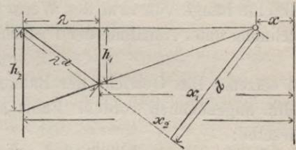
$$x = \frac{x_1 h_2 - x_2 h_1}{h_2 - h_1}$$
