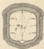
Querschnitt des Stollen V. 1:150.
