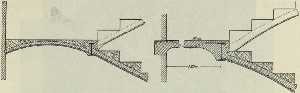
Abb. 62 und 63. Treppen mit Monierplatten bzw. Gewölben.
