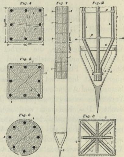
Abb. 82. Eisenbetonpfähle für einen Landungssteg in Noworossysk.
