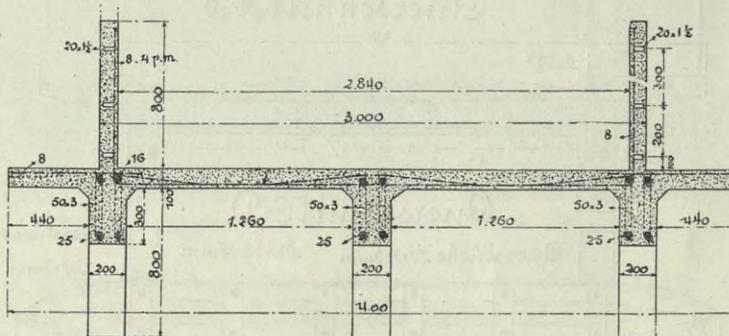
Abb. 120. Querschnitt einer Wasserleitungsbrücke. (System Hennebique.)
