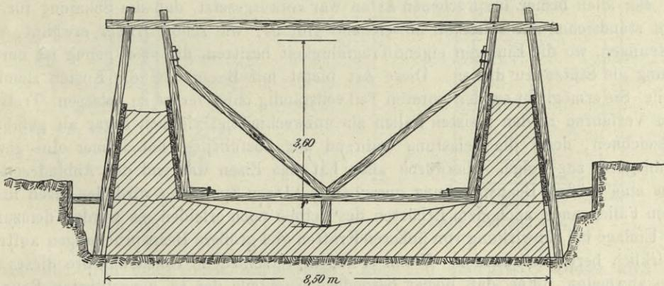
Abb. 207. Einschalung des Betonkanals der Versuchsanstalt in Dresden-Übigau.
