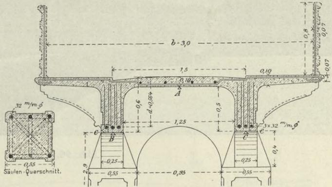
Abb. 92 und 93. Querschnitt einer Fußgängerbrücke. (System Hennebique.)
