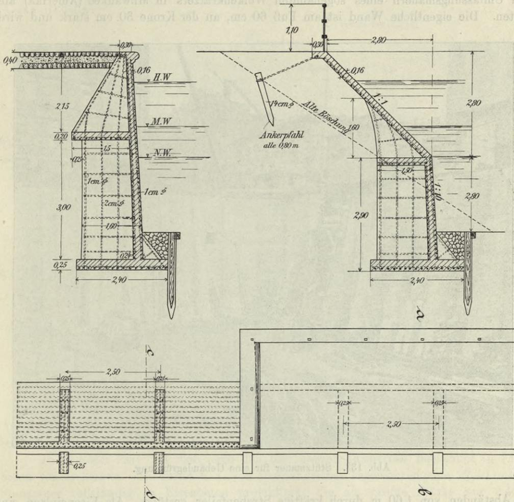
Abb. 130—132. Stützmauer und Uferdeckung in Eisenbeton.
