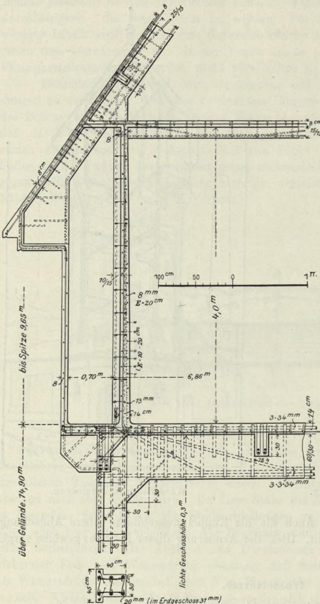
Abb. 156—158. Schnitt durch den Behälter des Wasserturmes in Kirchseon.
