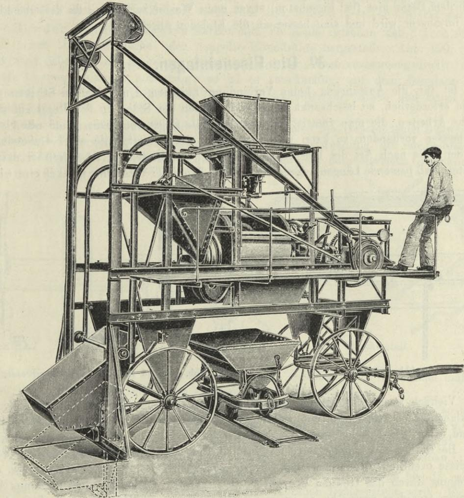
Abb. 186. Betonmischmaschine mit Motorbetrieb der Firma Gauhe, Gockel & Cie. in Oberlahnstein.
