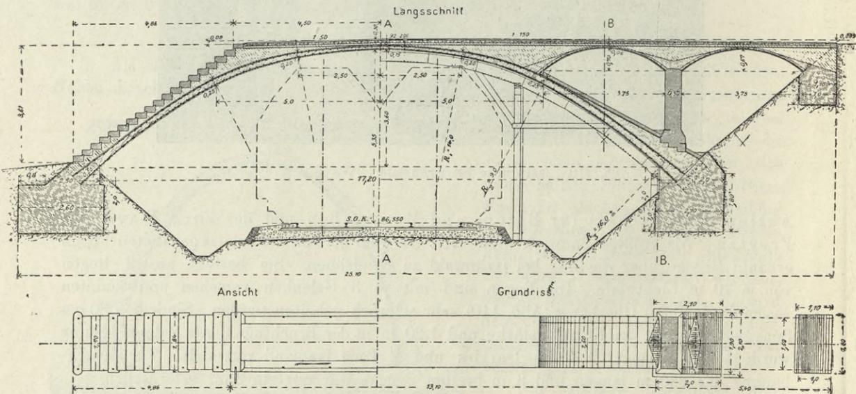
Abb. 112 und 113. Fußwegüberführung auf der Eisenbahnlinie Koblenz-Trier.
