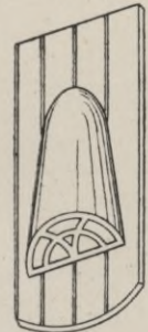
Abb. 166. Dachziegel mit Luft- öffnung.
