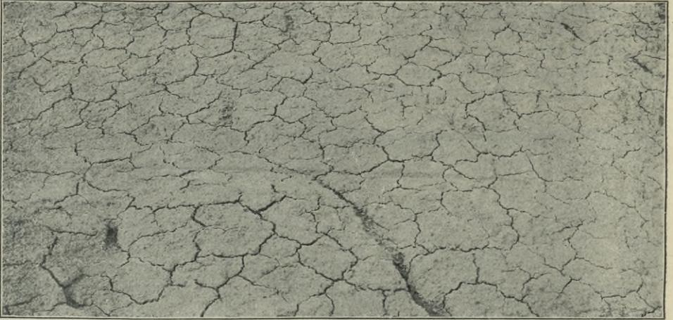
Fig. 17. Trockenrisse in Ton.
