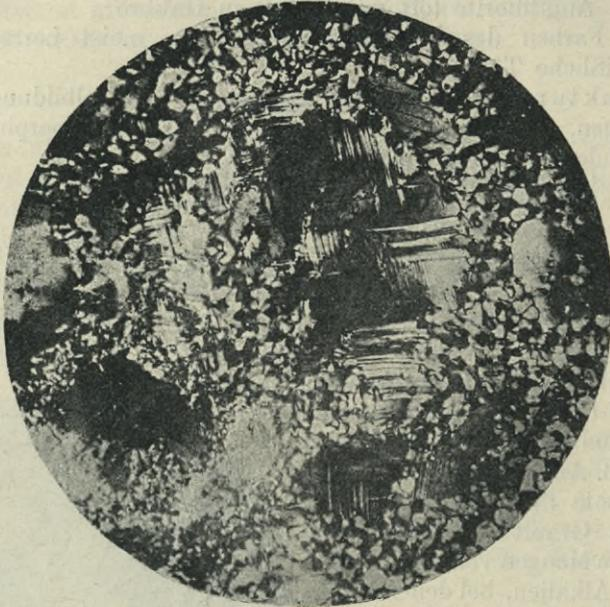
Fig. 249. Durch Gebirgsdruck innerlich zermalmtor Gabbro.
