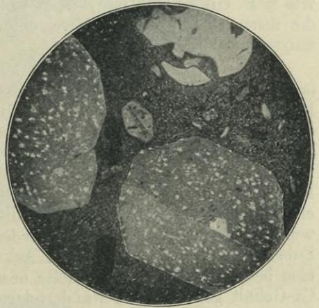
Fig. 300. Kaolinbildung aus Feldspat.
