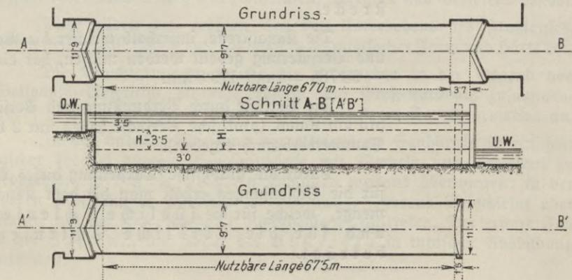
Fig. 14. Abmessungen der Schleusen.
