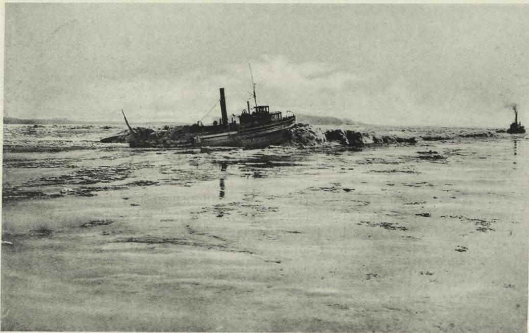
Rammartiges Arbeiten eines Eisbrechers.
