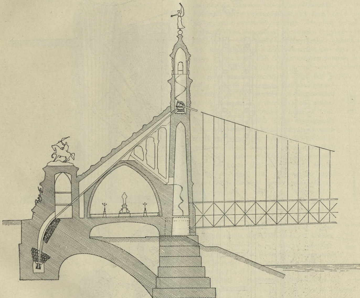
7. ábra. A kábelek fölfüggesztése és lehorgonyozása a módosított terv szerint.
