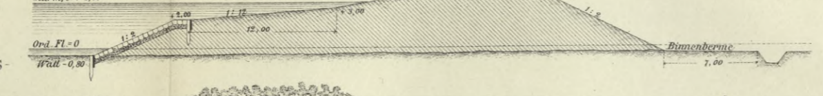
Fig. 4-8, Fig. 12-15. Querprofile von See- und Strommündungsdeichen.
