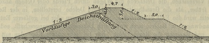
Fig. 25. Normaler Querschnitt des Weichseldeiches Gemlitz-Schmerblock.
