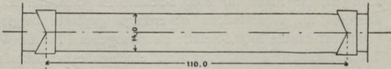
Im übrigen entspricht die Form des Querschnittes der bisher vorgesehenen. In den Auftragsstrecken ist eine noch grössere Wassertiefe vorgesehen. Dadurch werden Auftragsmassen gespart und der Schiffswiderstand wird geringer. Die Dichtung des Kanals wird allerdings etwas schwieriger.
