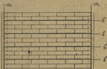
Rys. 64 Sklepienie płaskie syst. Klejnia na kant Brut a - belki b - wkładki
