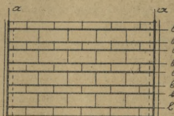
Rys. 65 Sklepienie płaskie syst. Klejnia na kant i na płask na zmianę a - belki b - wkładki
