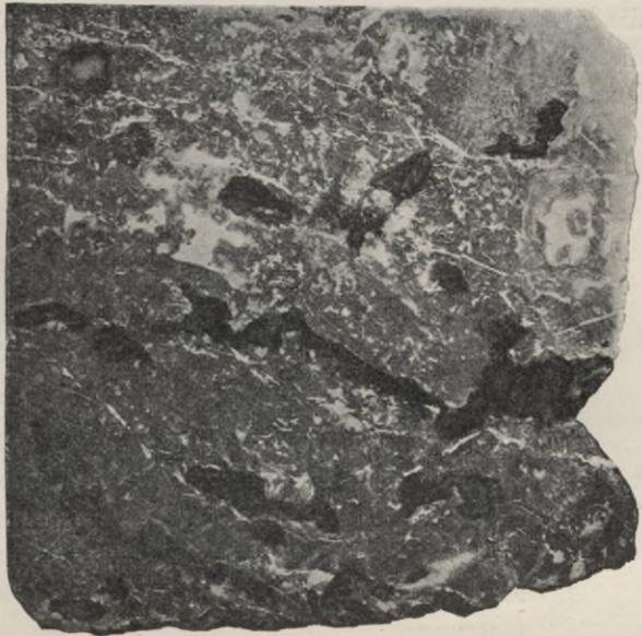
Fig. 269. Einzelne Fliese von Rouge belge desselben Fußbodens. Ausgetretene Tonadern bis zu  $2\frac{1}{2}$  cm Tiefe. Maßstab 1:8.
