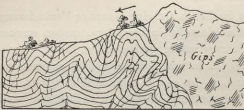
Fig. 18. Faltung der Schichten durch einseitige Zusammenstauchung.
