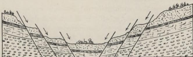
Fig. 27. Kesselbruch im Querschnitt.
