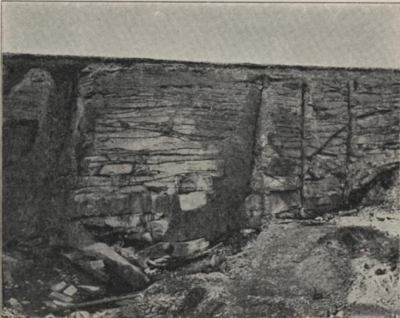
Fig. 4. Plattenförmige Absonderung im Lausitzer Granit (nach O. Herrmann).
