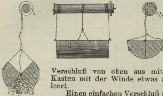
Verschluss von oben aus mittels Leine geöffnet und der Kasten mit der Winde etwas angehoben, wobei er sich entleert.
