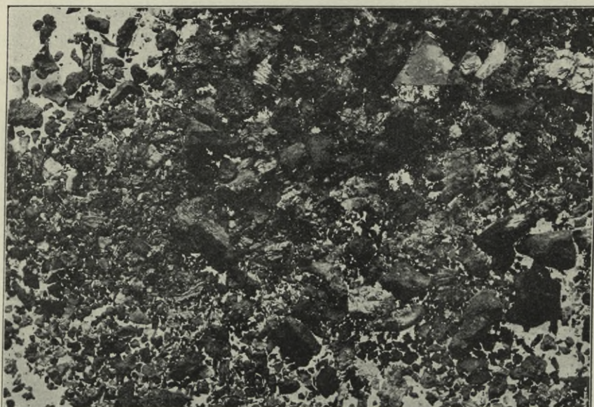
Abb. 11. Korngrößen der Lokomotivlösch: 0—25 mm.
