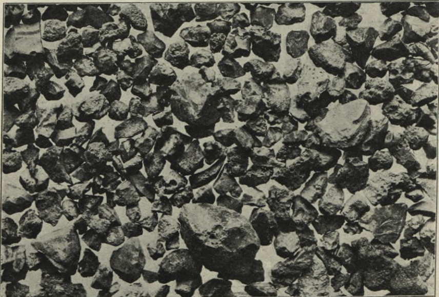
Abb. 9. Korngrößen des Hochofenschlackenschotter (Pochsand): 7—20 mm.
