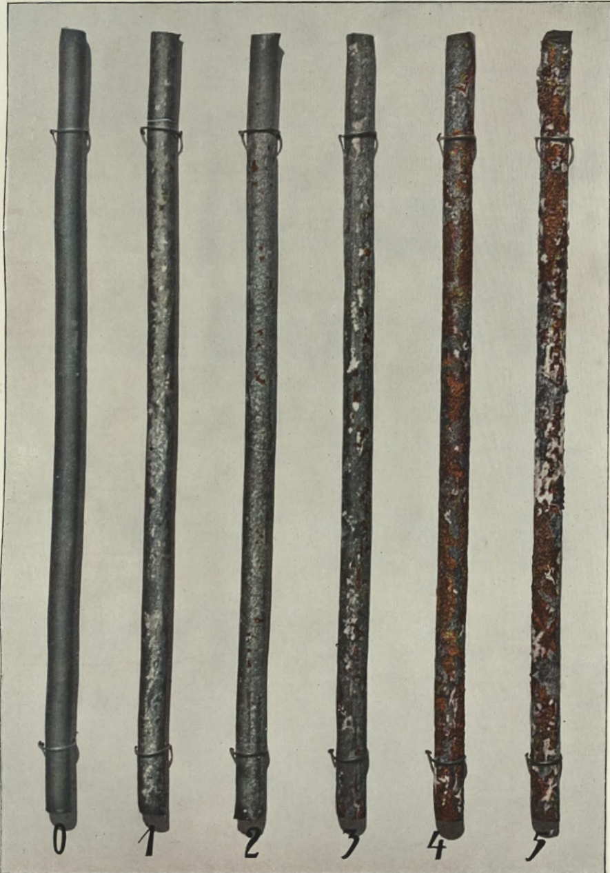
0: Zustand des Eisens vor dem Einbetten in die Betonkörper. 1—5: Grad der Rostbildung nach Beendigung der Dauerversuche.
