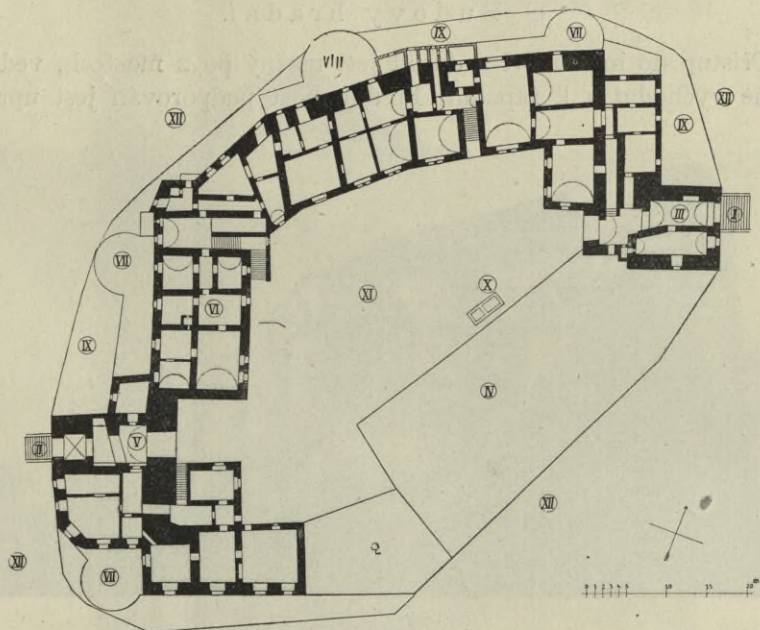
Obr. 146. Nové Hradky. Püzdorys hradu. Vysvětlení: I. Přední most. II. Zadní most. III. Přední brána. IV. Zbořeně křídlo hradu. V. Zadní brána. VI. Palác hradní. VII. Bývalé obranné věže. VIII. Bývalá velká věž. IX. Parkán. X. Studna. XI. Dvůr hradní. XII. Příkop kolem hradu. — Plan du château. Légende: I. Le premier pont. II. Pont de derrière. III. Première porte. IV. Aile démolie du château. V. Porte de derrière. VI. Palais du château. VII. Anciennes tours défensives. VIII. Ancien donjon. IX. Courtine. X. Puits. XI. Cour du château. XII. Fossé autour du château.
