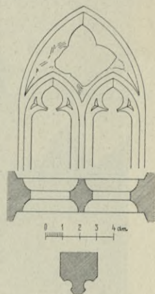
Obr. 324. Postupice. Zbytek gotick. okna. Profil žebra.
