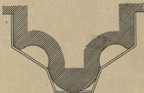
Obr. 57. Radnice. Profil vítězného oblouku. 1/20.
