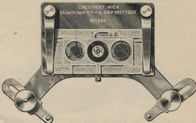
Abb. 42. Reichert'scher Plattenkondensor mit Schieberblende und neuer Befestigungsvorrichtung.
