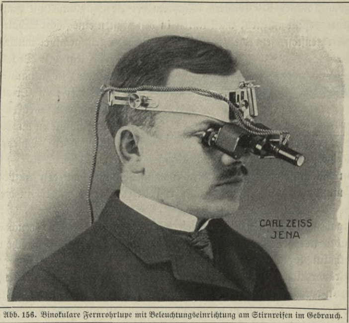
Abb. 156. Binokulare Fernrohrlupe mit Beleuchtungseinrichtung am Stirnreifen im Gebrauch.
