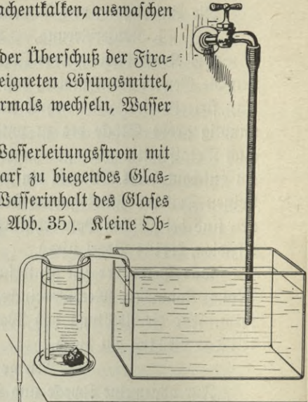
Abb. 35. Wässerungsvorrichtung: an die Wanne können sehr zahlreiche Gläser angeschlossen werden.
