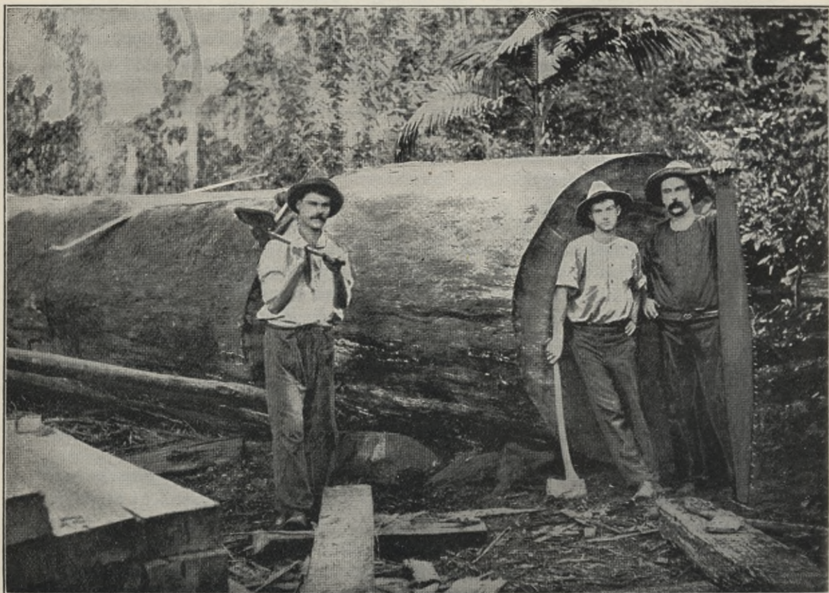
Abb. 28. Behauen von Blue Gum zu Eisenbahnschwellen.
