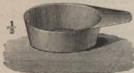
Man wägt auf dem Tarirblech genau 3,0 g Zucker ab, bringt denselben verlustlos in das Platinschälchen und durchfeuchtet ihn vollständig mit reiner, concentrirter Schwefelsäure. Nach wenigen Minuten beginnt dieselbe den Zucker zu schwärzen und zu zerstören und beim Erhitzen, am besten über einer möglichst grossen Flamme, erfolgt schnell eine vollständige Verkohlung unter bedeutendem Aufblähen, Zischen und lebhafter Gasentbindung.
