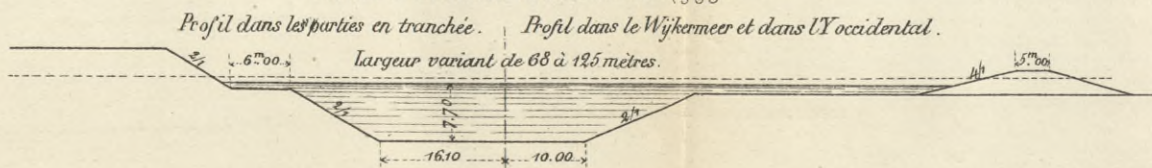
Canal d'Ymuiden. Sections: \begin{cases} 370\text{m}^2 \\ 385\text{m}^2 \end{cases}
