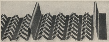
Abb. 245. Streckmetall mit steifen Rippen.
