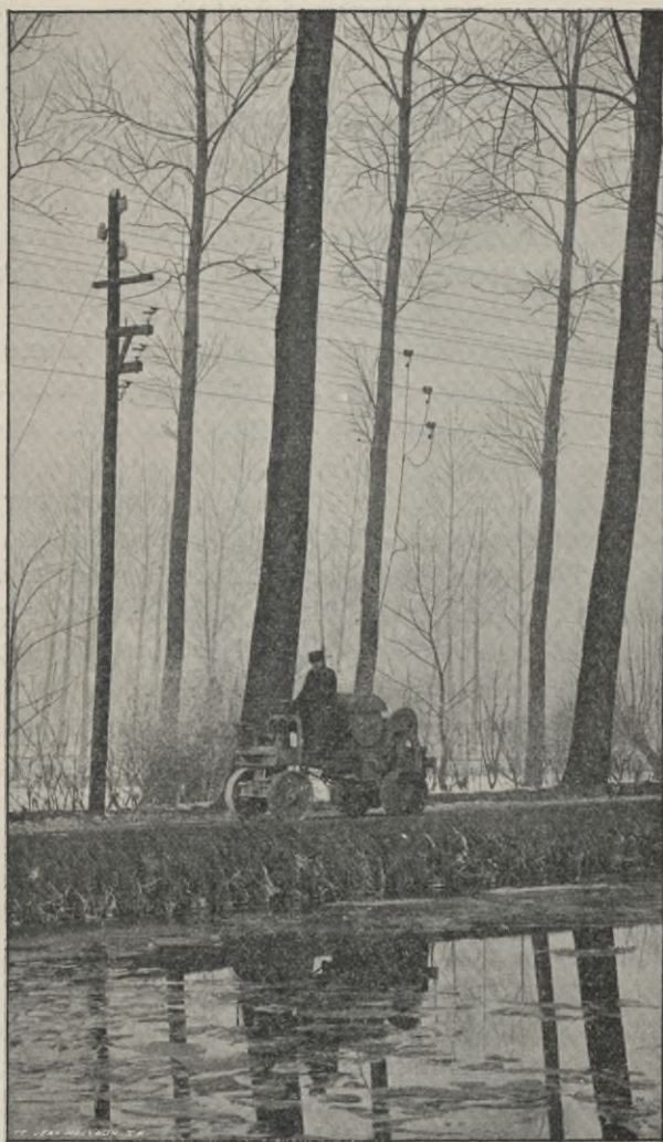
FIG. 1. — Tracteur polyphasé (modèle à adhérence sur berges).
