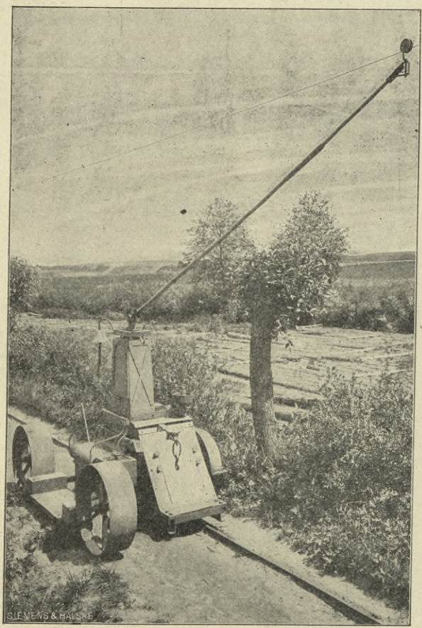
Fig. 9. Schlepplokomotive für die Einschienbahn. (Locomotive de traction pour la voie ferrée à rail unique.)
