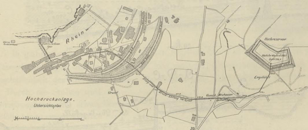
auf einen 135 m hoch gelegenen Behälter mit 28 000 cbm Inhalt zu heben, um diesen Druckwasservorrat in zwei Hochdruckturbinen von je 500 PS auszunützen und so die übrigen Maschinenleistungen zur Zeit des stärksten Strombedarfs zu ergänzen.<sup>1)</sup>
