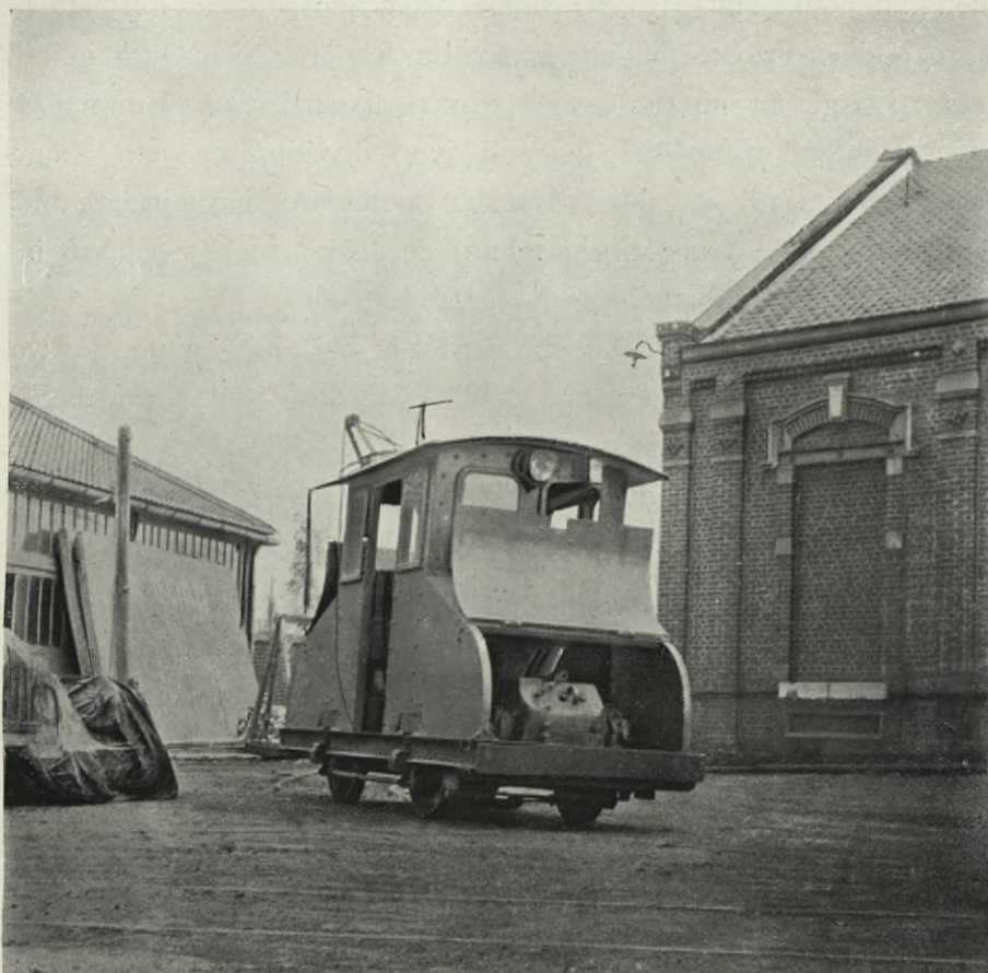
FIG. 217. — Rimorchiatore elettrico simmetrico a quattro ruote.
