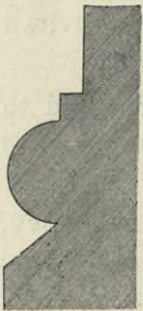
Obr. 100. Prepeře. Kolmý řez stranou sloupu.
