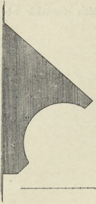
Obr. 146. Rovensko-Týn. Profil odkapní římsy na kostele.
