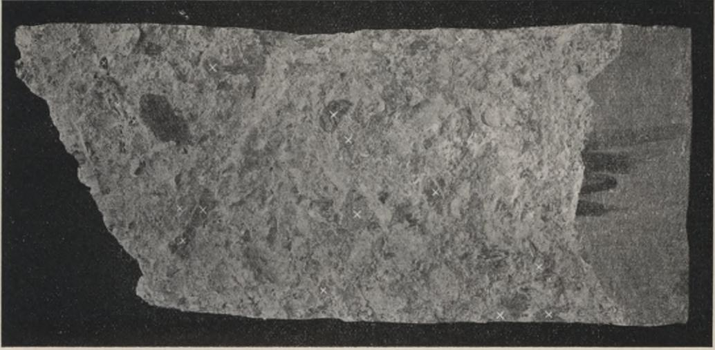
Abb. 5. Bruchfläche einer Druckprobe aus Steinschlagbeton.
