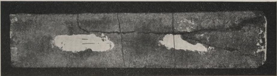
Abb. 3. Probe einseitig abgespaltet.
