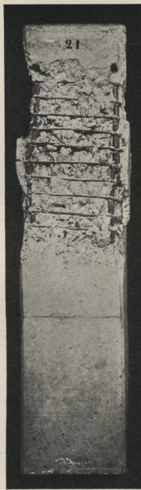
Abb. 18. Säulen 19 bis 21 mit Spiralbewehrung (0,5 cm Durchmesser).
