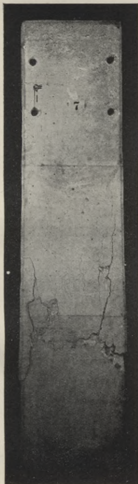
Abb. 14. Säulen 7 bis 9 mit Ringbewehrung (0,5 cm Durchmesser, umgehakt).
