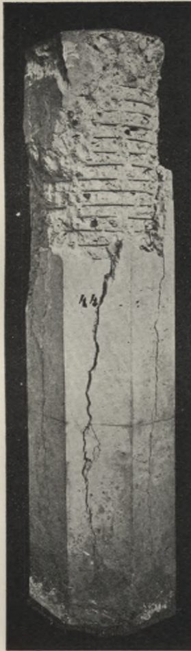
Abb. 26. Säulen 43 bis 45 mit Spiralbewehrung (0,7 cm Durchmesser).
