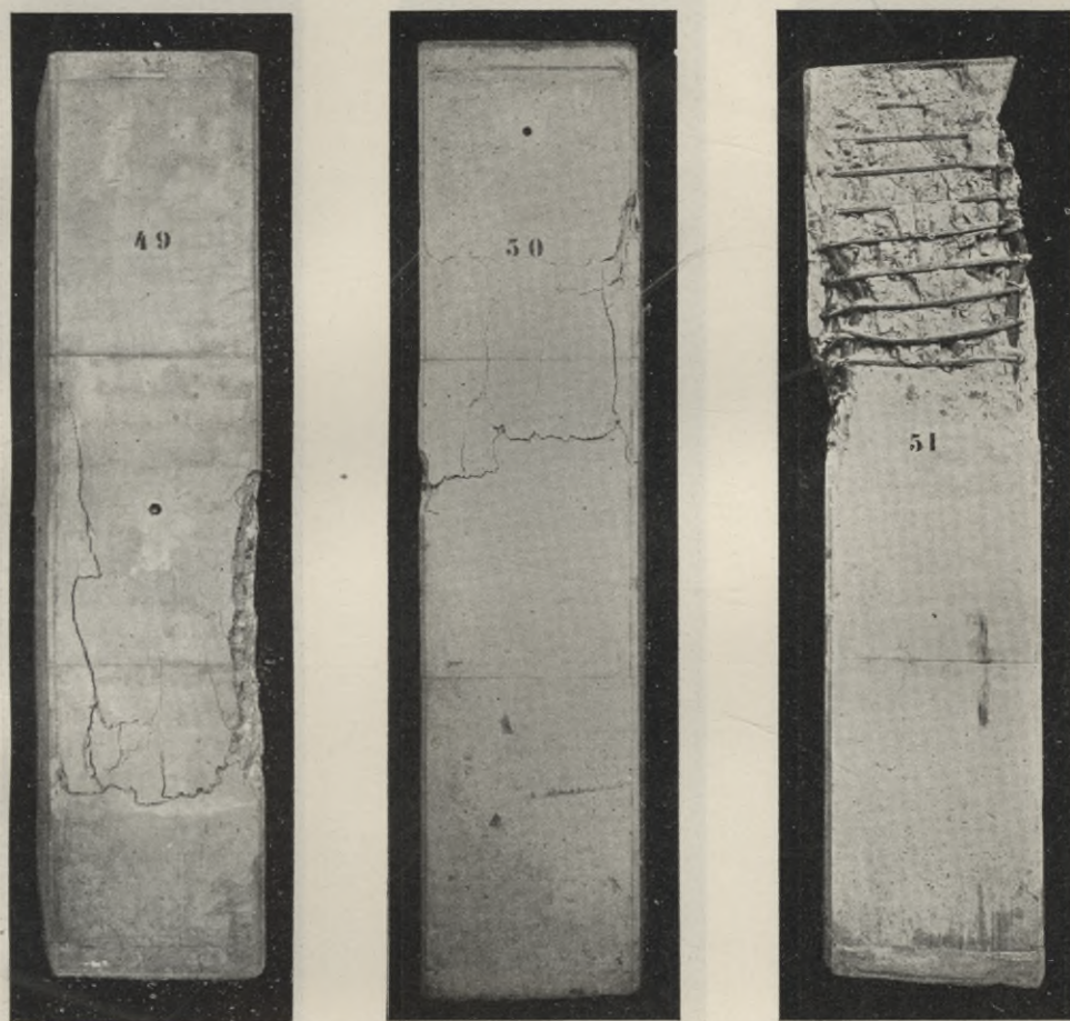
Abb. 28. Säulen 49 bis 51 mit Ringbewehrung (0,7 cm Durchmesser, umgehakt).
