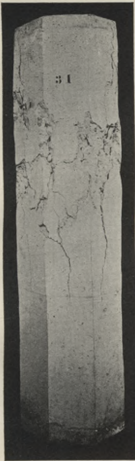
Abb. 22. Säulen 31 bis 33 mit Ringbewehrung (0,7 cm Durchmesser, geschweißt).
