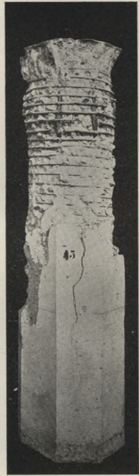
Abb. 26. Säulen 43 bis 45 mit Spiralbewehrung (0,7 cm Durchmesser).
