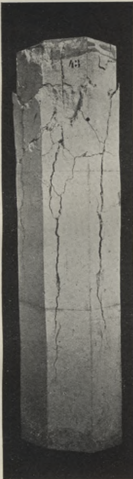
Abb. 26. Säulen 43 bis 45 mit Spiralbewehrung (0,7 cm Durchmesser).
