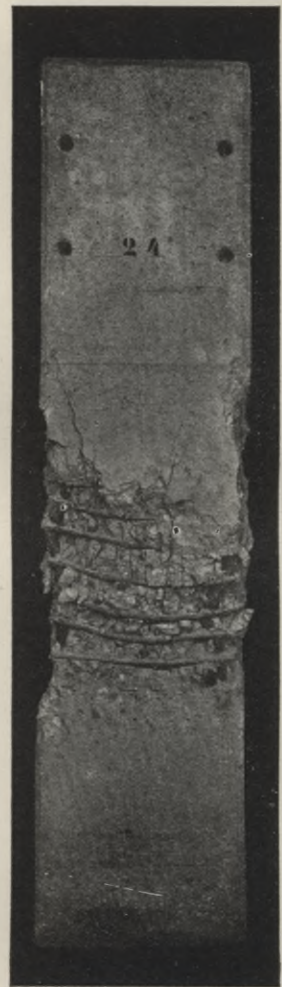
Abb. 19. Säulen 22 bis 24 mit Spiralbewehrung (0,7 cm Durchmesser).
