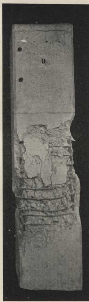
Abb. 14. Säulen 7 bis 9 mit Ringbewehrung (0,5 cm Durchmesser, umgehakt).
