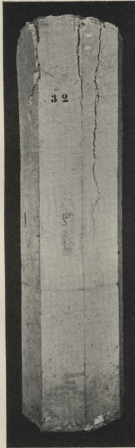
Abb. 22. Säulen 31 bis 33 mit Ringbewehrung (0,7 cm Durchmesser, geschweißt).
