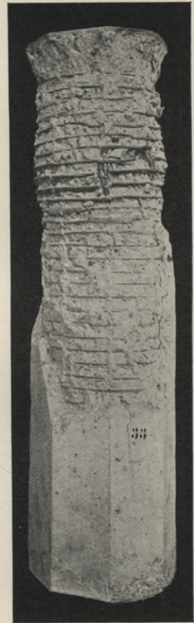
Abb. 22. Säulen 31 bis 33 mit Ringbewehrung (0,7 cm Durchmesser, geschweißt).
