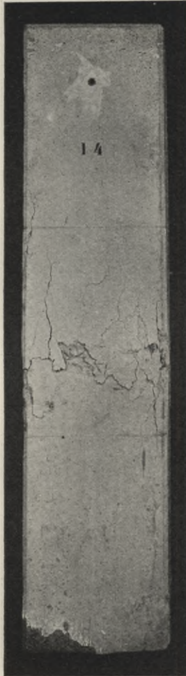
Abb. 16. Säulen 13 bis 15 mit Diagonalbügel (0,5 cm Durchmesser).
