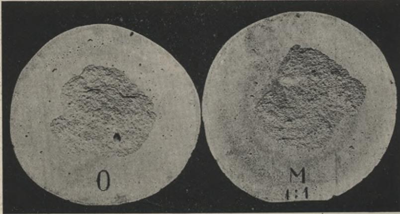
Abb. 9. Kuchen aus reinem Zement mit abgesprengter Oberfläche.
