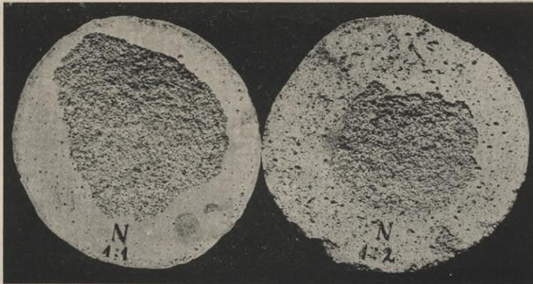
Abb. 10. Kuchen aus Zementmörtel 1:1 und 1:2 mit dichter, zu Absprengungen neigender Oberfläche.
