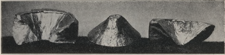
Abb. 10. Stauchprobe aus Messing; Druckkegel und gesprengtes Ringstück.
