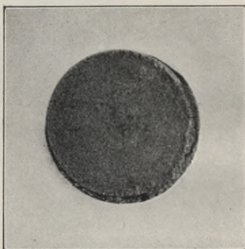
Abb. 13. Uebergehen des Materials aus dem Mantel der Druckprobe in die Druckfläche durch Anstauen nach dem Entstehen des Druckkegels.
