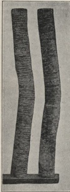
Abb. 14. Umschnürte Betonsäulen mit zusammenhängendem Betonkern nach dem Einknicken.
