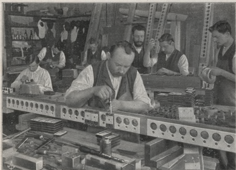
Bild 7. Anschrauben der elektrischen Ventile.
