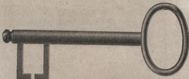
Eine größere Sicherheit erlangt man durch die Scheibe *l* mit den Ringen *m* Fig. 299 und 300, zusammen Befassung genannt, und durch Schenkelftiste *rr* an den Schloßblechen *rr* befestigt. Diese verhindern jeden Schlüssel, der mit seinen Einschnitten nicht genau in die Ringe paßt, in der Umdrehung. Noch besser ist es, wenn man nach Fig. 303 noch dergleichen Ringe an den Schloßblechen anbringt.
