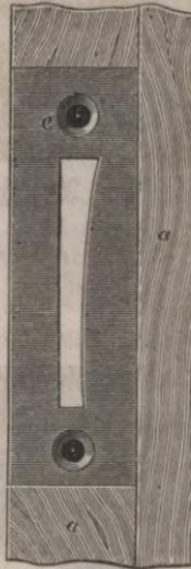
schluß besteht darin, daß ein Arm über einen, am Pfosten *a* Fig. 336 geschraubten Haken *g* geworfen wird und somit den Flügel *b* fest an den Pfosten *a* preßt. Bei *e* befinden sich Schutzbleche. Bei beweg-
