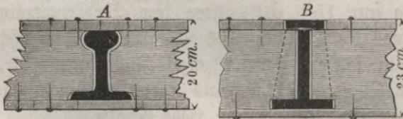
Soll also der zu überdeckende Raum nicht unbedingt vollkommen frei erscheinen, so empfiehlt es sich, die Träger mittels eiserner Säulen zu unterstützen (Fig. 144 A und B). Die Träger *a* sind hier zweimal von eisernen Säulen *x* unterstützt und die Balken *b* in der bekannten Weise über die Träger gelegt (Fig. 144 A). Letztere können entweder aus Guß- oder Schmiedeeisen, einfach oder doppelt T-förmig gestaltet sein.
