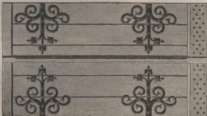
welches auf dem Rahmholz von einem starken und breiten Lappen überdeckt und mit Schraubenbolzen an der Thür befestigt wird. Der Haken hat ebenfalls einen in die Wand eingelassenen Lappenkolben.
