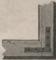
Bei größeren und eleganteren Fensteranlagen werden die Flügel mittelst Fischbändern mit dem Rahmholze verbunden.
