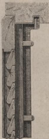
die Hülßen als Führung dienen und ihrerseits auf einem Eisenblech aufgenietet sind, das wiederum mit Schrauben oder Nägeln auf die Thür befestigt ist, während die Schließhülse in dem Gewände angebracht ist.
