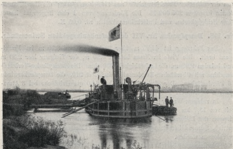
Das Spülpreßschiff der Elbstrombauverwaltung.
