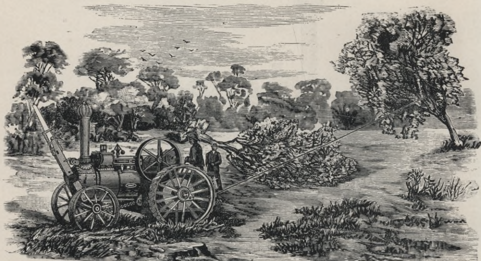
Abbild. 23. Fowlers Straßenlokomotive in ihrer Tätigkeit beim Wiederreißen von Bäumen, z. B. zum Freimachen des Schussfeldes vor Festungen, Anlage von Verhauen usw.
