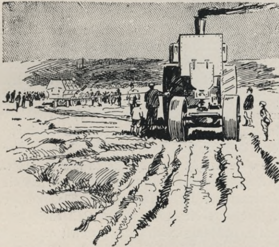
Abbild. 20. Bug mit Anwendung der Winde und des Drahtseils.
