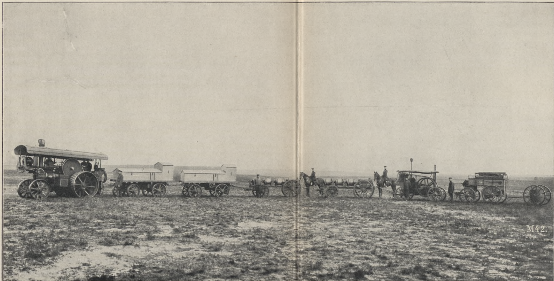
Militär-Straßenlokomotive von John Fowler & Co. in Magdeburg auf dem Transport, mit angehängtem Wagenzuge des elektrischen Scheibenzugapparates, auf dem Truppenübungsplatz in Munster in Hannover.
