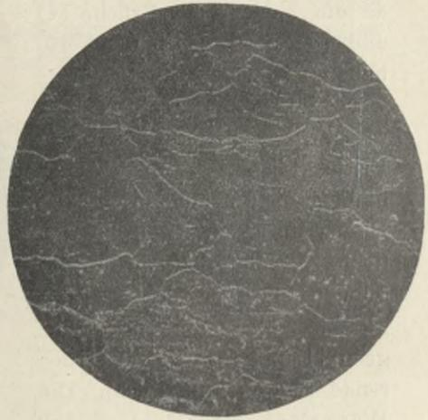
Gefüge einer Eisen-Silizium-Legierung mit 2,26% Silizium bei 800° C.
