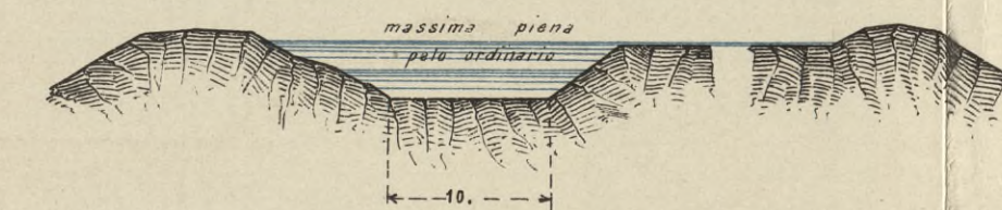
Sezione attraverso il Canal di Loreo
