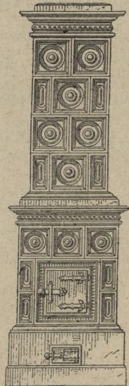
Eisendraht verbunden, so dass der Ofen, welcher sich beim Heizen ausgedehnt hat, beim Erkalten die ursprüngliche Form wieder annehmen muss. Der Heizraum wird aus feuerfesten Chamotteziegeln und derlei Platten hergestellt, nicht aus Mauerziegeln, welche sehr bald durchgebrannt sind und ein Herausfallen der Heizthüren verursachen, wodurch der hermetische Abschluss ganz
