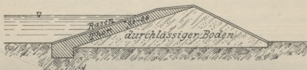
Fig. 475. Dichtung eines Deiches durch Tonböschung.
