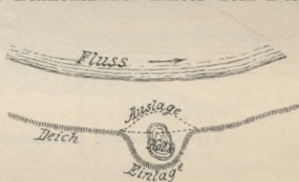
Fig. 477. Wiederherstellung des Deiches nach dem Deichbruch.
