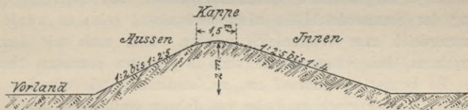
Fig. 473. Querschnitt eines Sommerdeiches von 2 m Höhe.
