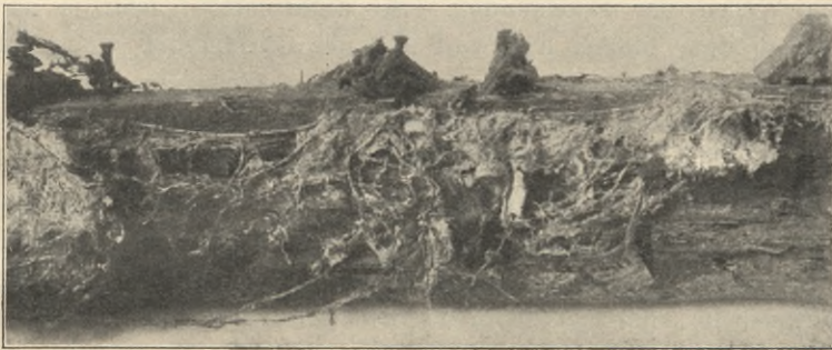
Fig. 3. Stück eines der Eichenlager mit ansitzenden Merulius -Häuten, oben Reste und Nägel des zerstörten Blindbodens auf dem unveränderten Eichenholz, unten partielle „Trockenfäule“ (s. Text).
