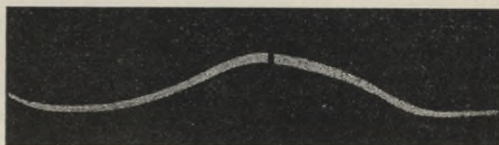
Fig. 412 a. Wechselstromkurve vor einem Kabel.
