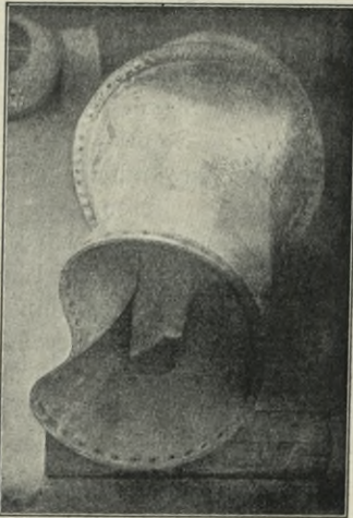
Fig. 29. — Infolge Wassermangels deformiertes Feuerrohr.
