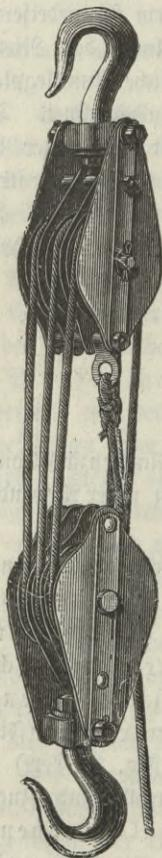
Fig. 1. Seilflaschenzug mit 3 Rollen in jeder Flasche.
