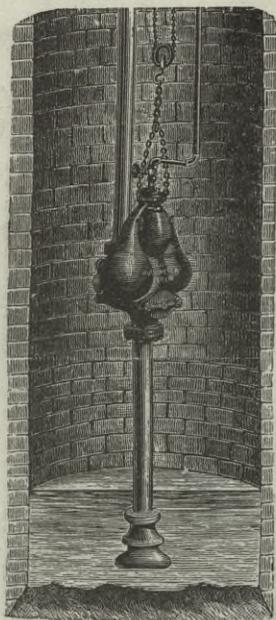
Fig. 90. Aufhängung des Hall'schen Pulsometers in einem Brunnenschacht.
