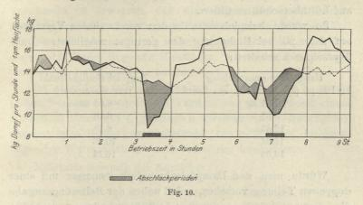
Im Diagramm Figur 10 ist ein Betriebsbild des vorerwähnten Dampfkessels gegeben. Die stark ausgezogene Linie stellt die aus den Angaben des Dampfgeschwindigkeitsmessers abgeleitete Belastung der Heizfläche in Kilogrammen pro Stunde und Quadratmeter dar. Naturgemäß geht die Dampfproduktion mit der Zunahme der Rostverschlackung abwärts, um in der Abschlackperiode ein Minimum zu erreichen.
