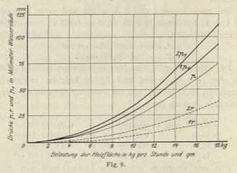
pro 1 qm und Stunde durch eine Rohrleitung von 175 mm lichtem Durchmesser an seinen Verwendungsort, so erhält man einen Differenzausschlag von  $\sim 89,2$  mm Wassersäule, wenn man den einen Manometerschenkel 3 m von dem anderen in die Rohrleitung münden läßt.
