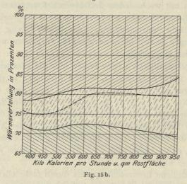
Man erkennt, daß mit der Zunahme der Beanspruchung der Zugansaugungsanlage die Größe des Luftüberschusses fällt und schließlich bei einer maximalen Inanspruchnahme ein variables Verfeuern in Bezug auf Luftüberschuß unmöglich ist, d. h. die Zugansaugungsanlage ist erschöpft. Das Minimum an Luftüberschuß, mit welchem dieser oder jener Brennstoff
