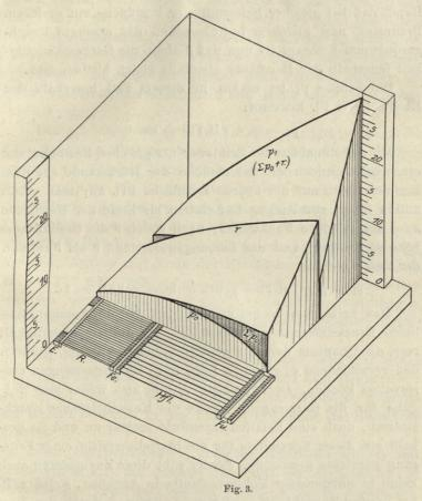
Die Summation dieser Werte gelangt in der Kurve  $p_1$  zum Ausdruck, das ist der Wert, der durch ortsübliche Zugmessung als Zugzahl in Millimetern Wassersäule ausgedrückt wird.
