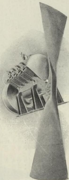
Abb. 299. Stahlschraube von Renault.
