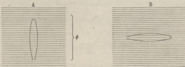
umschließt während einer Umdrehung zweimal ein Maximum von Kraftlinien (Stellung A in Fig. 4) und zweimal Null Kraftlinien (Stellung B in Fig. 4). Somit wird der maximal in die Windung
