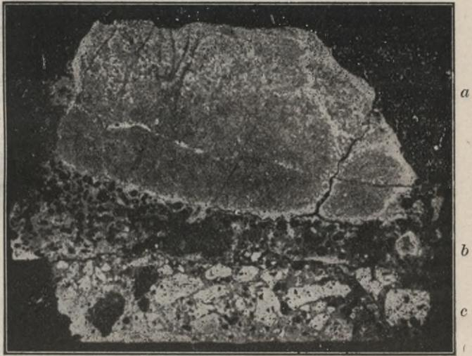
Mörtelstück von der röm. Wasserleitung bei Dalbenden (Eifel).
