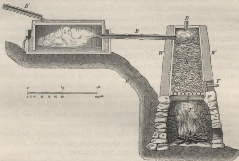
Fig 8. Apparat zur Kampfergewinnung in Tosa, Japan.
