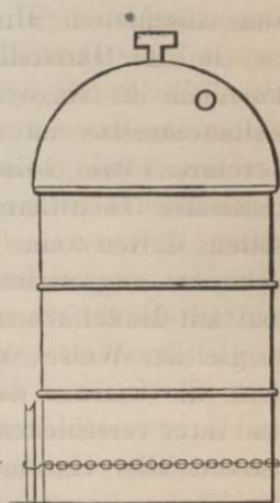
Fig. 20. Muffel zum Einbrennen von Schmelzfarben.
