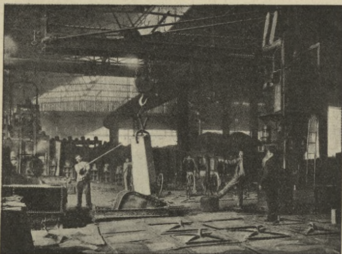
Fours Pitts ou Giers : Défournement des lingots d'acier au moment de les envoyer aux laminoirs
