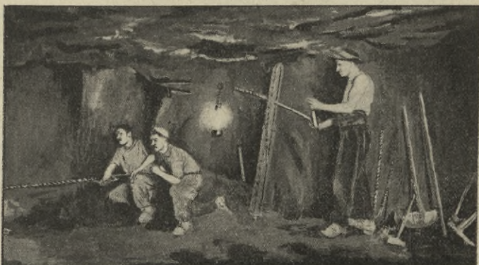
Mineurs de fer forant un trou de mine à la main
